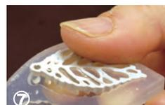
⑦ 型を反らせ、銀粘土をゆっくり取り外します。乾燥した銀粘土は割れやすいので注意してください。
