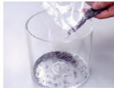
研磨槽の中にバレルチップを約50g〜70g入れます。ピンの量が多すぎると研磨力が落ちるので注意して下さい。
