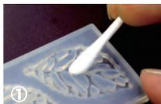
① 銀粘土を型から外しやすくするために、凹み部分にオイル(食用油)を薄く塗ります。
