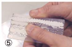
⑤ 型を上下に開くようにして銀粘土を剥がし、端からゆっくり取り外します。
