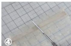
④ 銀粘土の表面に少量の水をなじませ、スパチュラなどで余分な銀粘土をすり切ります。
