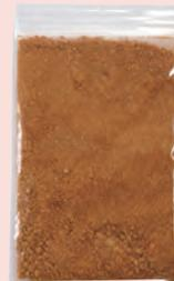
水200mlに対し、スプーン大さじ1杯の粉体コンパウンドと汚れたバレルチップを入れ、20〜30分間バレル研磨機を回転させると、バレルチップの汚れを落とす事ができます。
